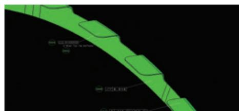
Abmessungen, Toleranzen und Anmerkungen definieren die Konstruktionscharakteristika des Laminats und werden in der Qualitätsplanungsumgebung (Quality Planning Environment, QPE) verarbeitet, damit ein vollständiger Satz Prüfanforderungen für das Vorhärten und das Nachhärten bzw. Tempern zur Verfügung steht.
